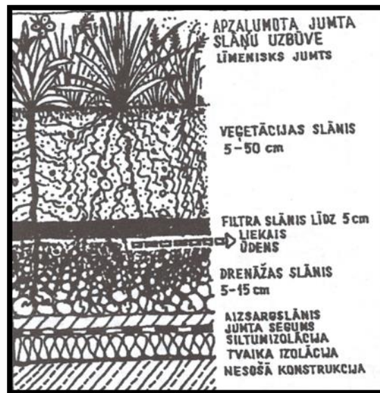
3.att. Līmenisko jumtu apzaļumošanas metode
